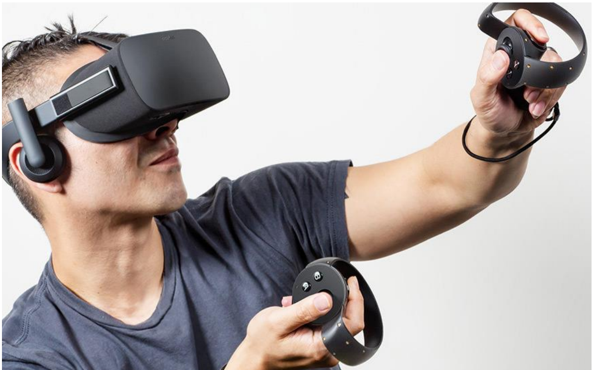
Figura 9 – Equipamento RV imersivo: óculos, auriculares e comandos
