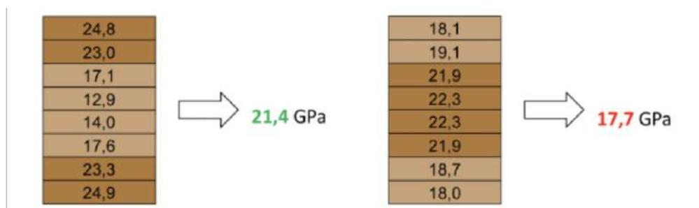
Imagem 54: Composição das lamelas em uma viga (fonte: Ita Construtora)
