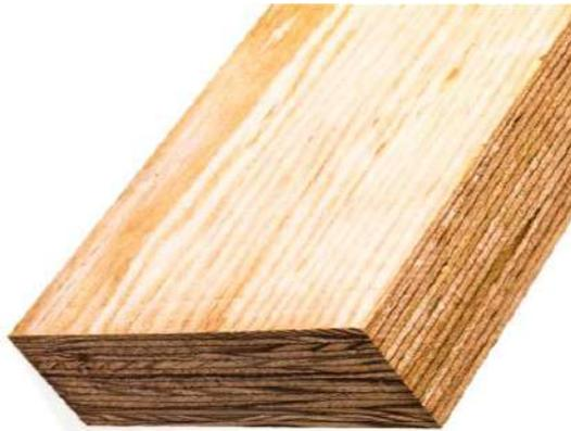
Imagem 6: Elemento em Painéis de Lâminas Paralelas.
