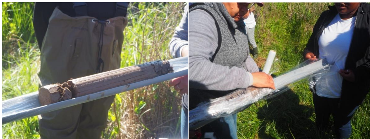
Figura 3. 5 e 3.5.1- Procedimento de armazenamento da recolha de testemunho de sondagem SMP1.
