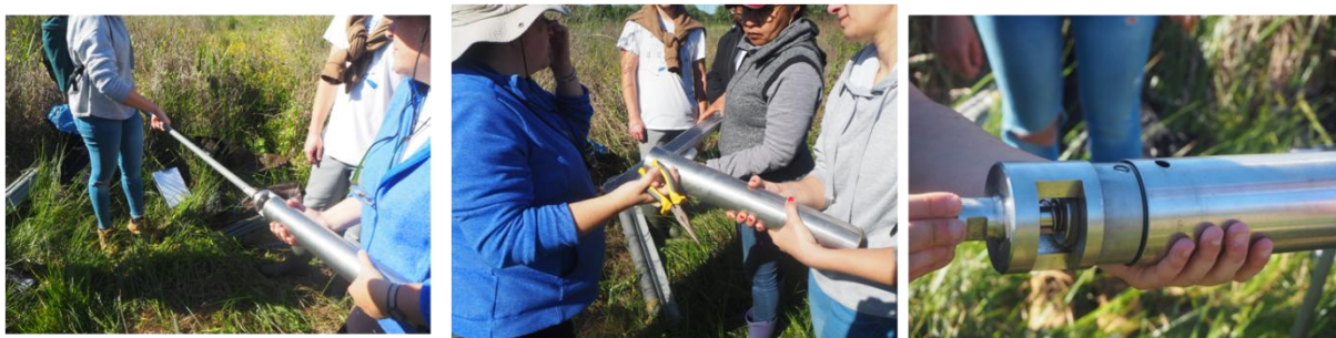
Recolha do testemunho de sondagem com a sondagem de prospeção Vander Horst .
