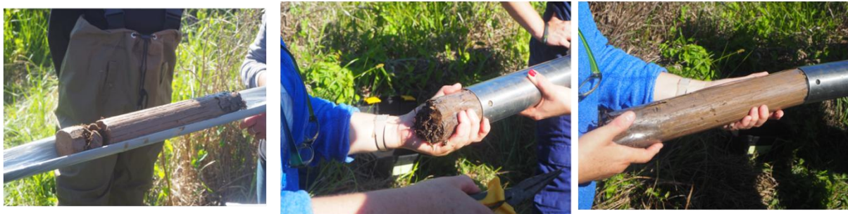
Recolha do testemunho de sondagem com a sondagem de prospeção Vander Horst .
