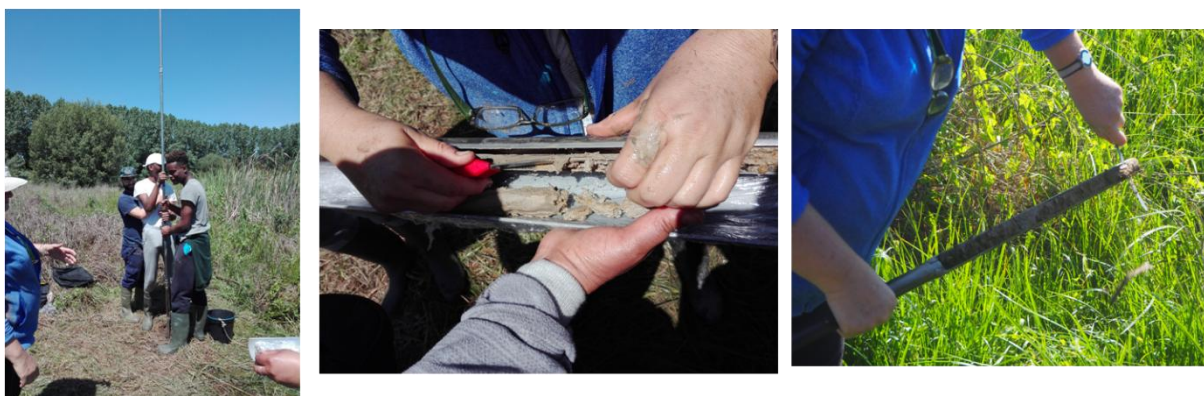
Recolha do testemunho de sondagem com a sondagem de prospeção Meia cana .
