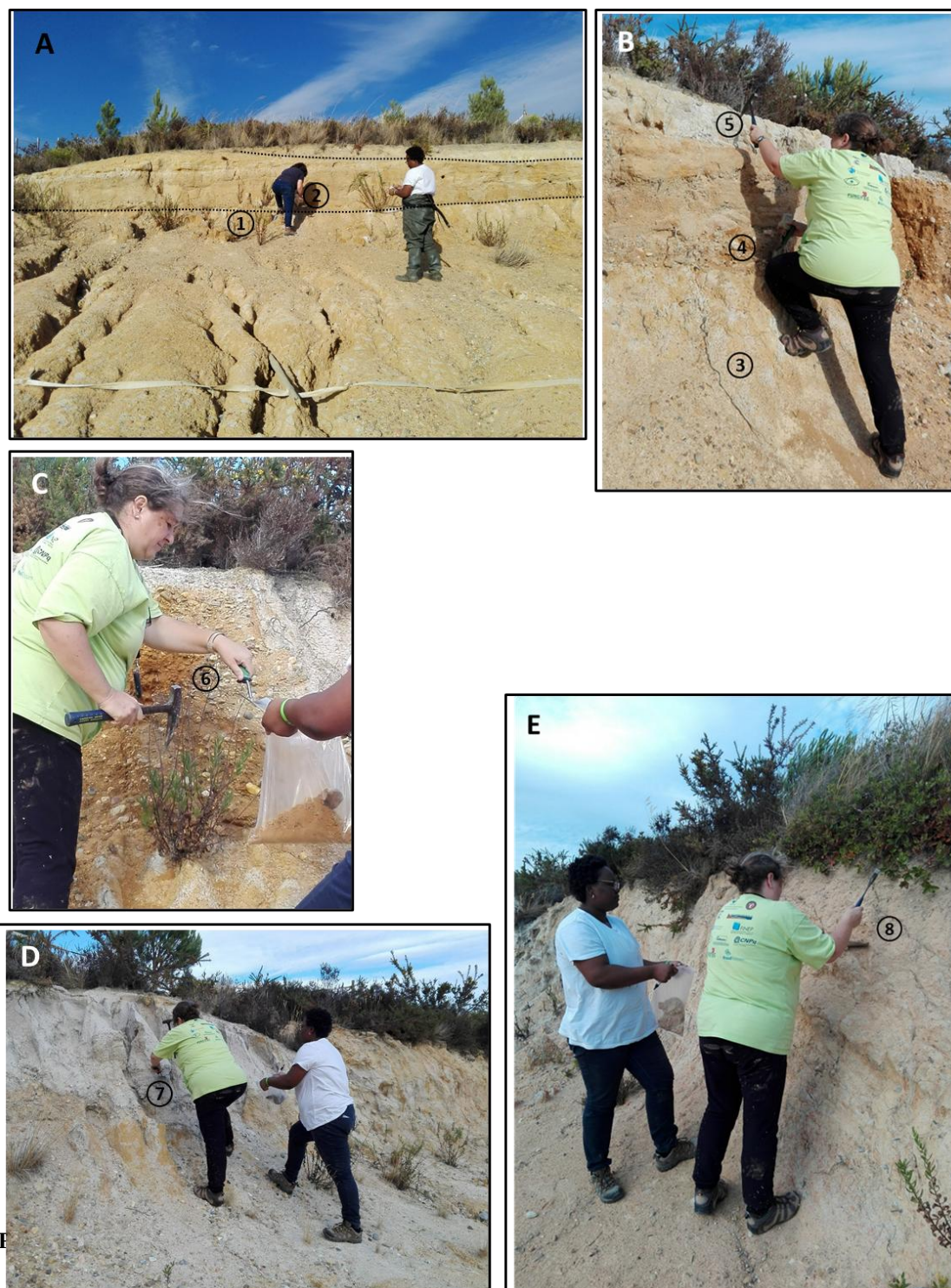
Figura 3. 6 (continuação) – Recolha de amostras no corte geológico com um conjunto de estratos que representam as litologias presentes no fundo do vale da Ribeira do Judeu. As camadas presentes neste afloramento são formações geológicas sedimentares essencialmente detríticas com intercalações carbonatadas com idades pertencentes ao Miocénico inferior a médio (M1-4: Complexo detrítico, da Ota e de Alenquer, com intercalações calcárias). Nesta região as camadas apresentam-se sub-horizontais. Os números de 1 a 8 representam a numeração atribuída às amostras recolhidas. As caixas com linha a preto, identificadas com letras, localizam as fotografias de pormenor no momento da amostragem (Fotos e montagem © A. Cruces).
