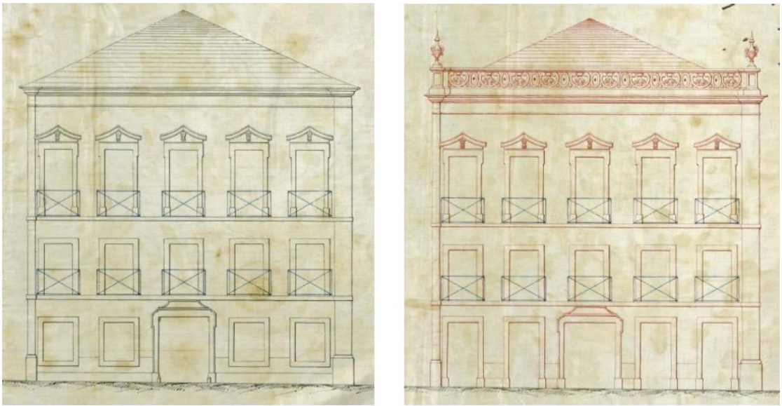
Figura 49 - Fachada principal – A existente versus a proposta de alteração e construção de platibanda (Arquivo CML, 1883).
