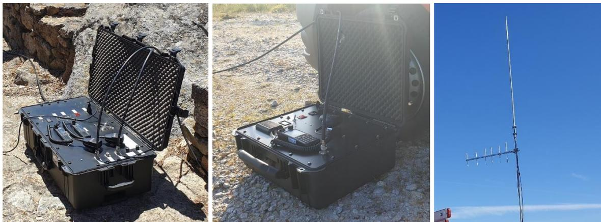
Figura 12 – Sistema de comunicações da banda alta de VHF; Figura 13 – Terminal TETRA com gateway/repeater; Figura 14 – Antenas TETRA omnidirecional e Yagi-Uda. Fonte: CBS Braga
