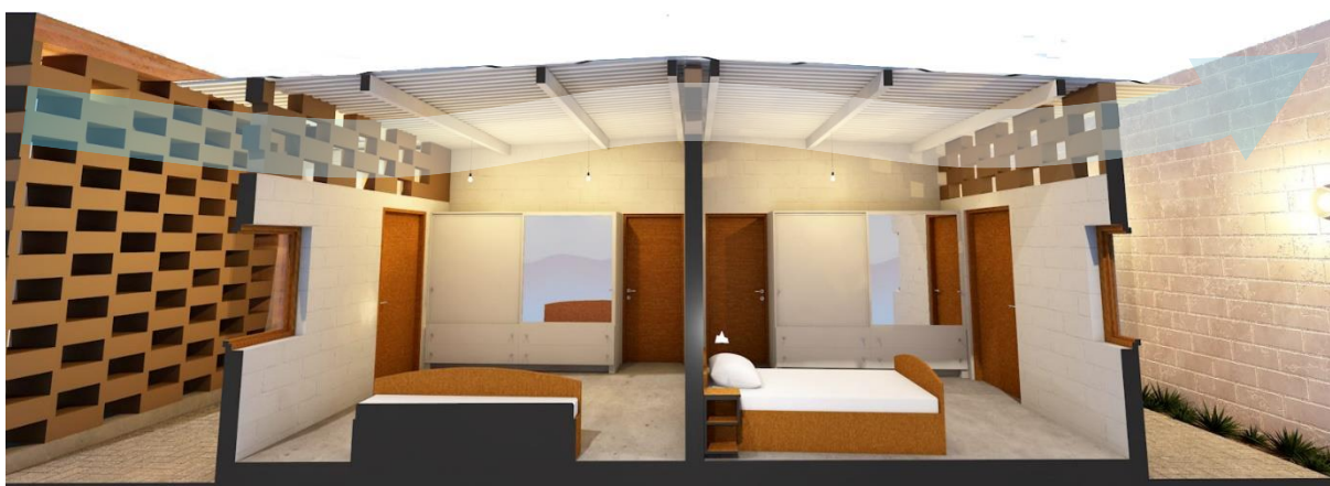
Figura 42 – Corte dos quartos, demonstrando a ventilação cruzada.
