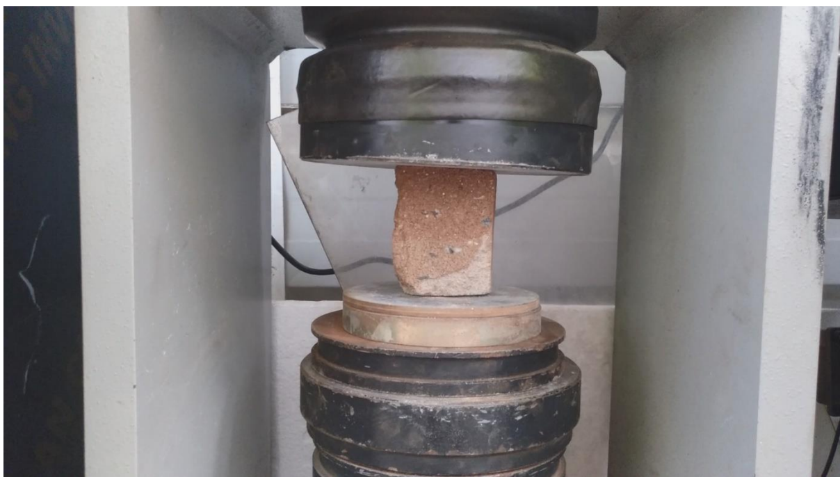
Fotografia 15 – Amostra de terra prensada sob teste de resistência à compressão.
