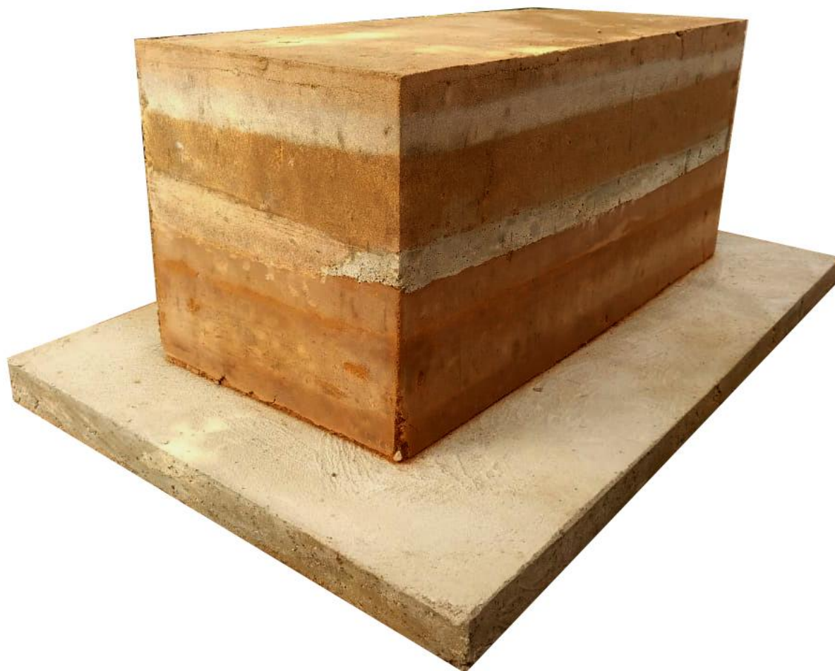
Fotografia 14 – Segmento da parede de terra prensada após descofragem.
