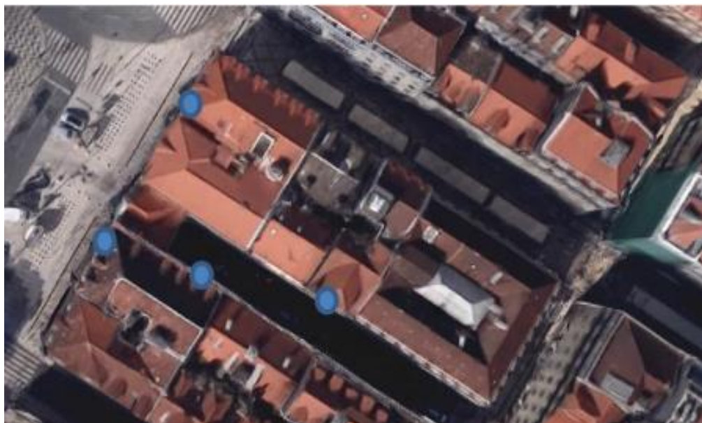
Figura 3.31 - Localização de alvos topográficos em edifícios contíguos (Nota Técnica de Observação e Localização de Alvos Topográficos, 2018).
