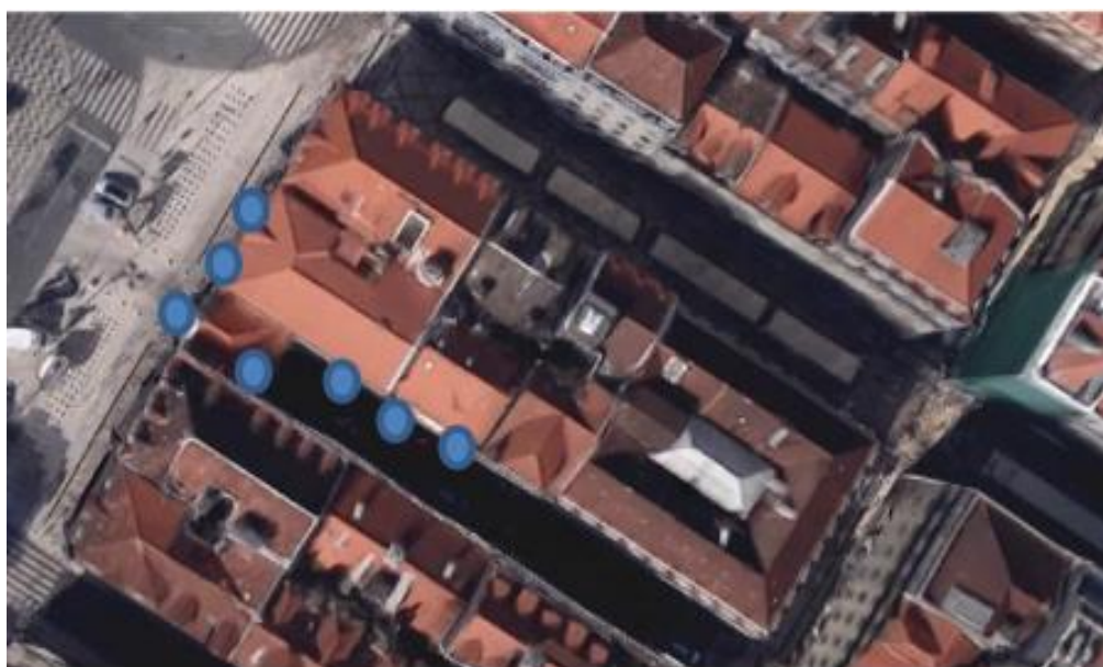
Figura 3.32 - Localização de alvos topográficos nas fachadas a manter (Nota Técnica de Observação e Localização de Alvos Topográficos, 2018).
