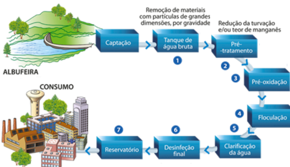
Figura 2 – Processo de tratamento de água potável numa ETA.
