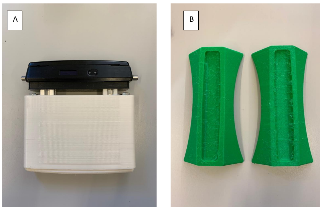
FIGURA 2 - MOLDES, PARA AUMENTAR O COMPRIMENTO DO DINAMÓMETRO (A) E PARA AJUSTAR ÀS PERNAS DOS JOGADORES
