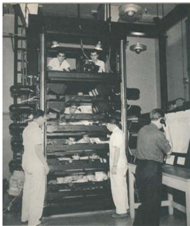
Fig. 1-2. Sistema multi-plane (Disney Studios)
