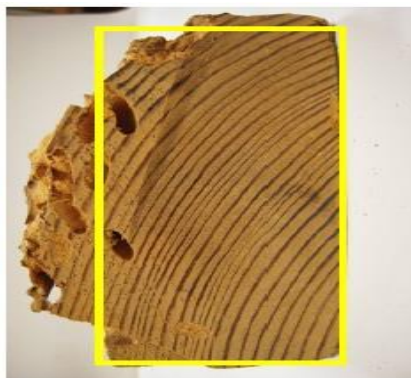
Fig.2.5.- Secção residual considerada resultante de ataque de caruncho
