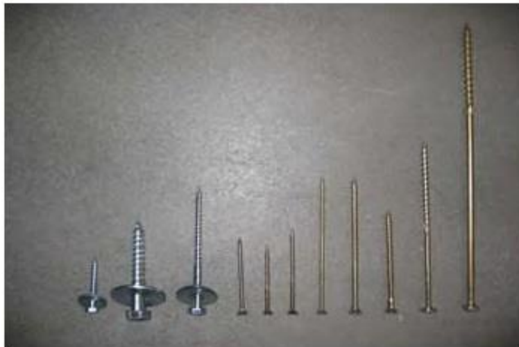
Fig.3.7- Parafusos de enroscar de vários tipos e tamanhos (Fonte: [35])
