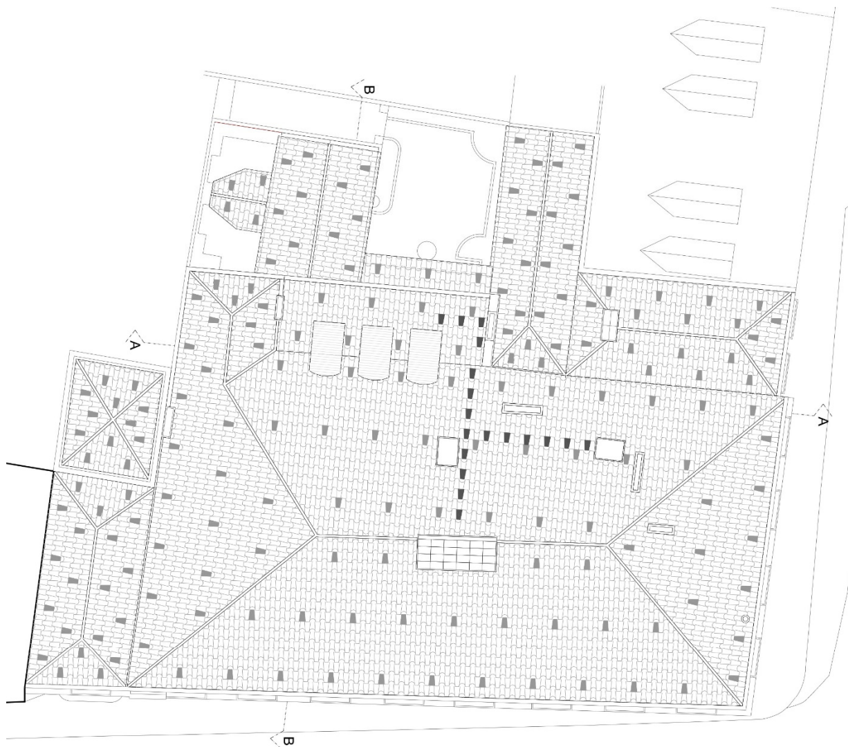
Planta de distribuição de telhas ventiladoras 19
