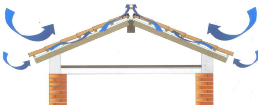
Fig.30. Esquema de ventilação com uma câmara-de-ar fonte: M.A.T.C (1998)
