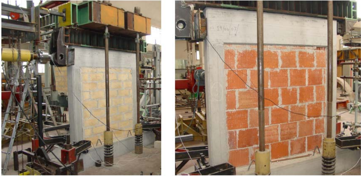
Figura 1.15 - Testes em pórticos preenchidos com diferentes tipos de alvenaria [44].
