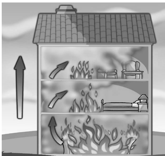
Figura 11 - Propagação do fogo por convecção
