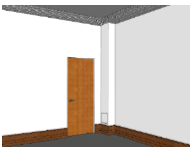
Fig. 39. Porta de Inspeção
