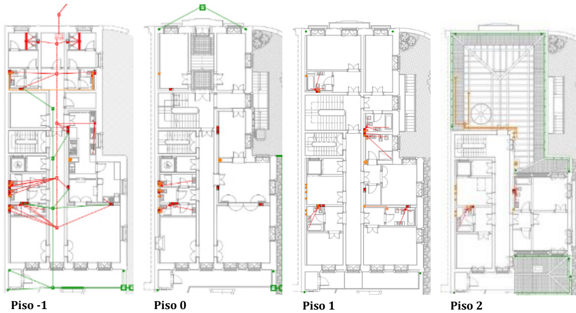
Fig. 112. Proposta de Saneamento e Ventilações
