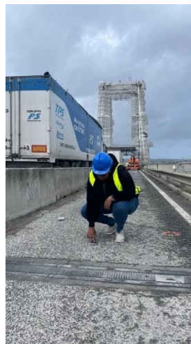
Figura 4.12 – Medição das frequências do tabuleiro da ponte.
