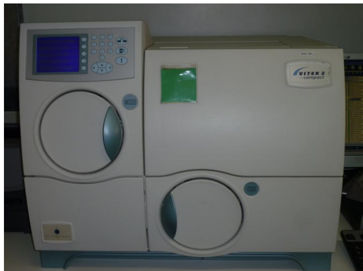
Figura 2 – VITEK 2, aparelho no qual é realizada a cultura e antibiograma de aeróbios. Obtida através do laboratório INNO ( fotografia recolhida pelo autor da tese).
