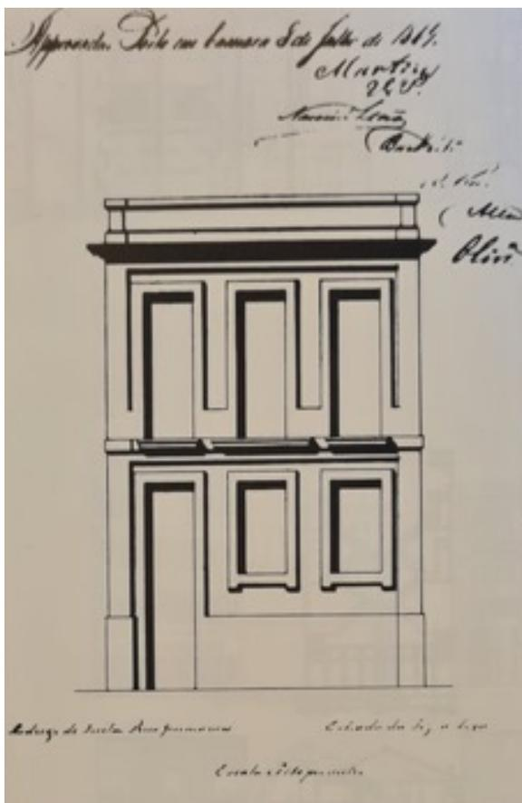
Figura 20 - Desenho do alçado de uma habitação unifamiliar, monofuncional, com o rés-do-chão sobrelevado, ainda sem cave é o primeiro exemplar, desta tipologia, com dois pisos registado nos livros “Plantas de Casas”.
