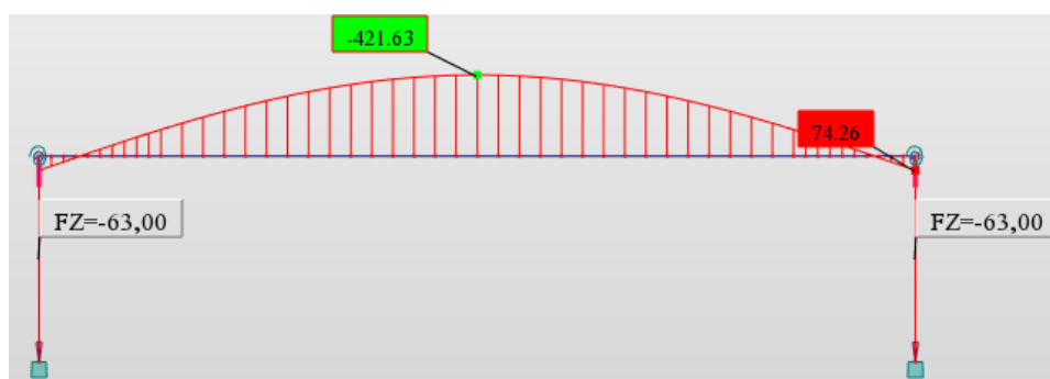
Figura 5.20 - Deslocamentos e reações para o sismo tipo 1 (RSA), no 2º modo de vibração (modelo calibrado)
