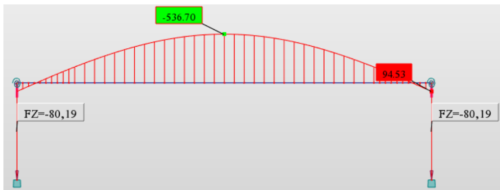
Figura 5.12 - Deslocamentos e reações para o sismo tipo 1 (EC8), no 2º modo de vibração (modelo calibrado)
