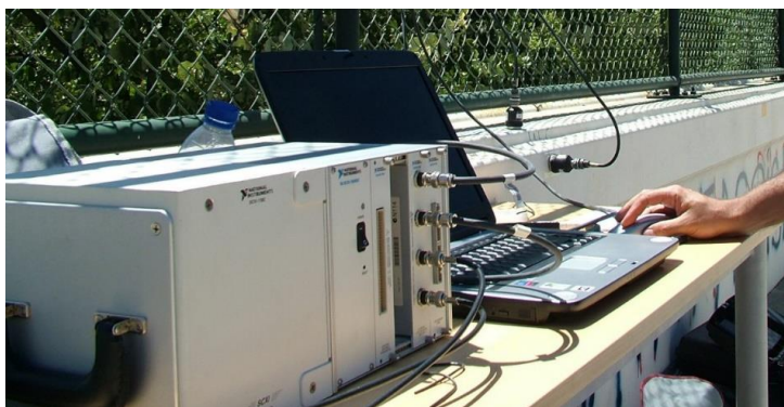
Figura 4.9 - Sistema de aquisição utilizado na campanha experimental
