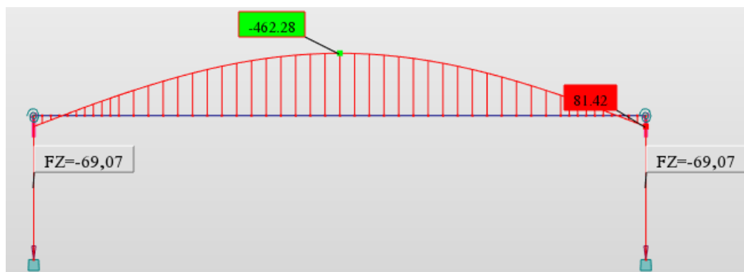
Figura 5.13 - Deslocamentos e reações para o sismo tipo 2 (EC8), no 2º modo de vibração (modelo calibrado)
