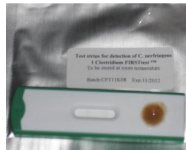
Figura 18 - Passo 6: aguardar 15 minutos, para migração da amostra
