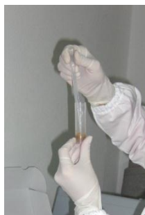
Figura 16 - Passo 4: pipetar o líquido sobrenadante com pipeta de Pasteur
