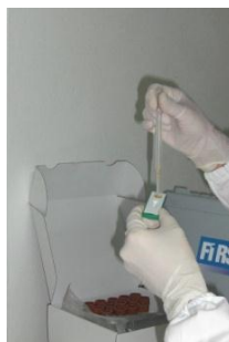
Figura 17 - Passo 5: encher o orifício da cassette
