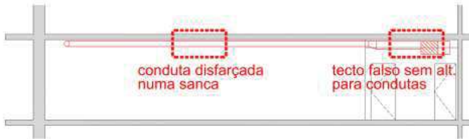
Figura 65 - Dimensão reduzida no tecto falso e conduta em sanca
