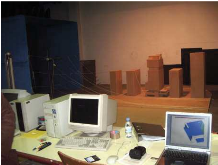
Figura 54 - Túnel de vento
