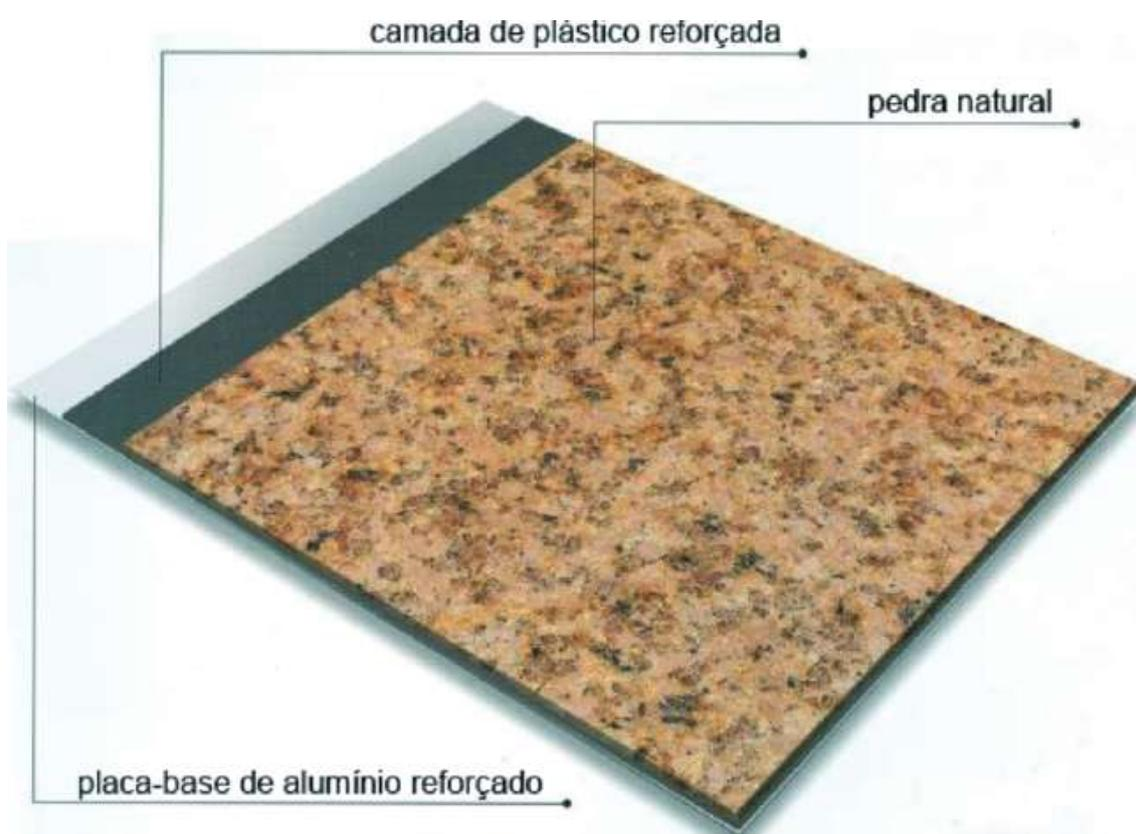
**Figura 11** - Placa de Pedra reforçada com compósito de alumínio
