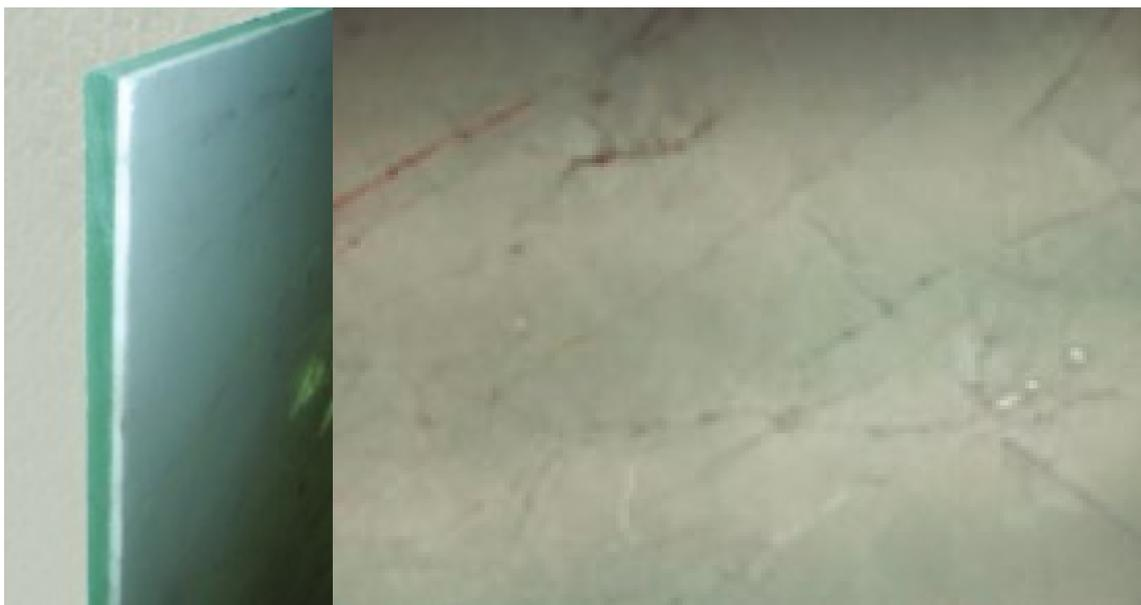
**Figura 14** - Placa de Pedra reforçada com placa de vidro
