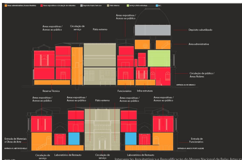
Figura 132 - MNBA: Cortes esquemáticos: usos e organização espacial.
