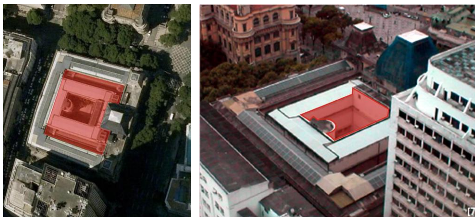
Figuras 121 e 122 - Esquemas de alteração do pátio do MNBA: à esquerda, área da construção original; à direita, área conforme reformas da década de 1920.
