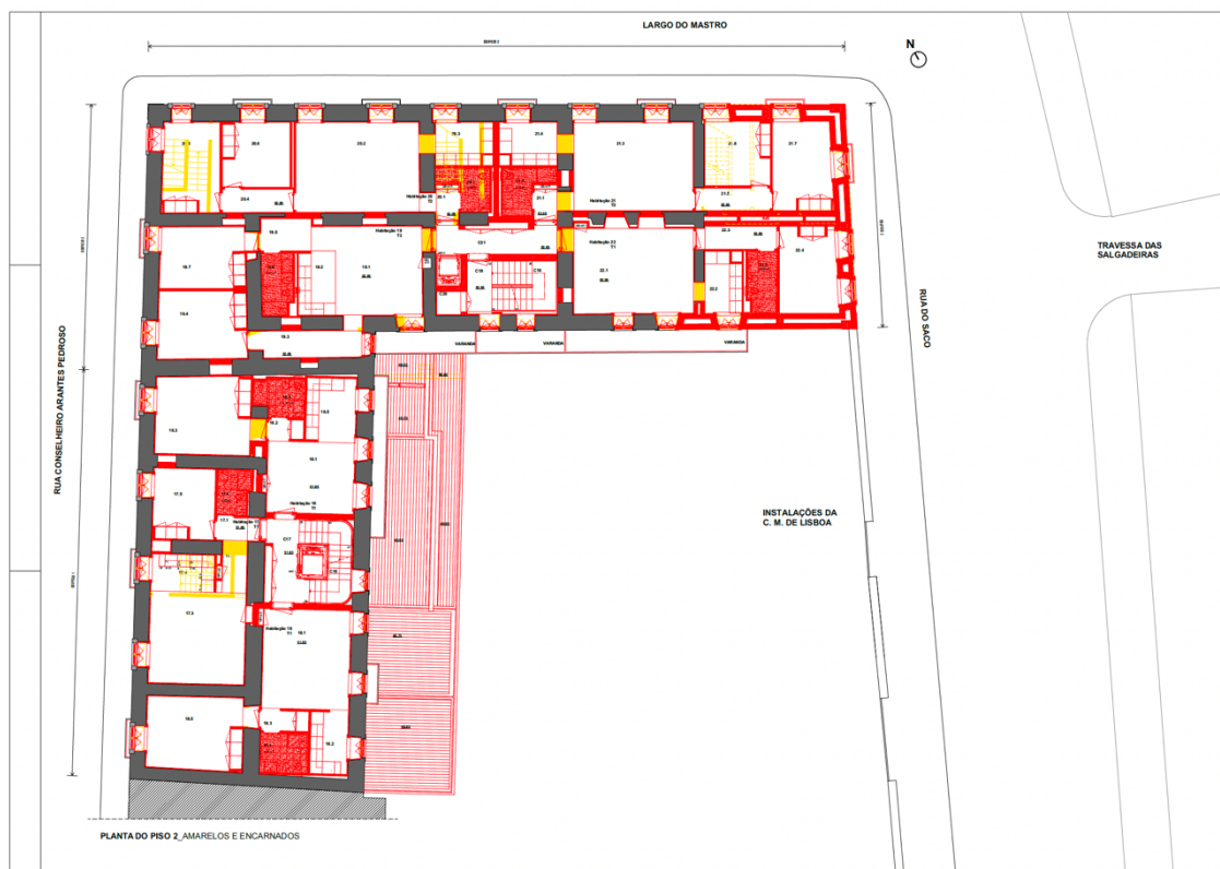
Figura 70. Edifício no Largo do Mastro, 1 a 10; projeto; planta 2.º andar evidenciando as alterações propostas e a reconstrução do topo nascente.
