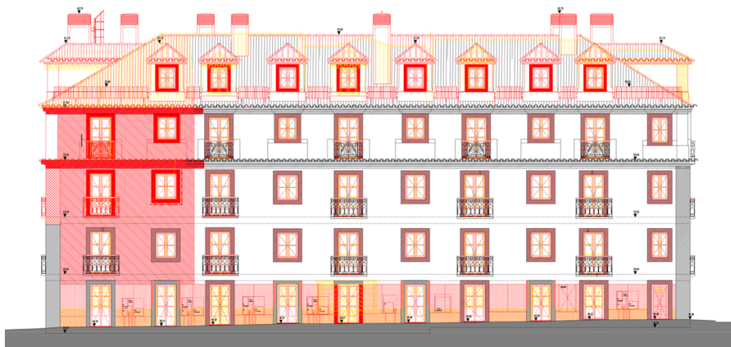
Figura 74. Edifício no Largo do Mastro, 1 a 10; projeto; alçado evidenciando as alterações propostas e a reconstrução do topo nascente.
