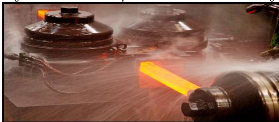
Figura 4. Cilindro de Laminação alterando a característica do tarugo.
