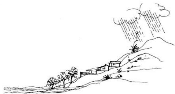
Figura 15- Esquema mostrando o lugar ideal para se implantarem as edificações em regiões de elevadas altitudes e chuvosas. (Guedes, 2011, p. 32)
