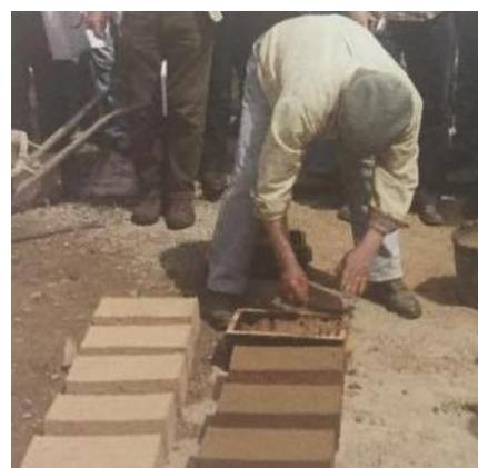
*Figura 49 – Processo de moldagem: remoção do molde e princípio do processo de secagem. (Fernandes & Tavares, 2016, p. 36)*
