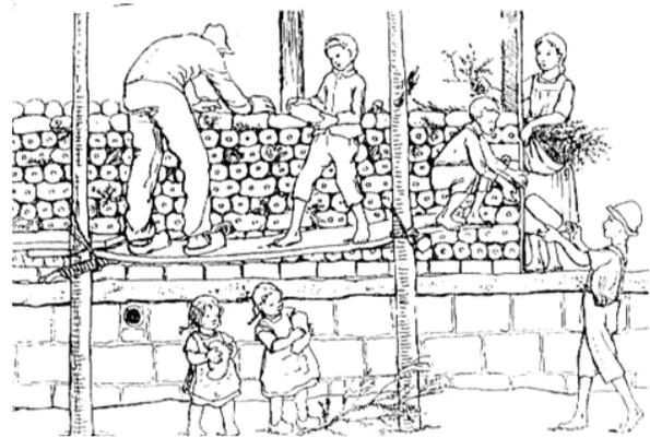
Figura 35– Construção com “pães de terra” alternados (Duarte, 2013, p. 36)
