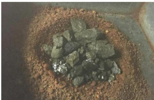
Figura 45– Extingção de cal dolomítica com terra arenosa, (Fernandes & Tavares, 2016, p. 35)
