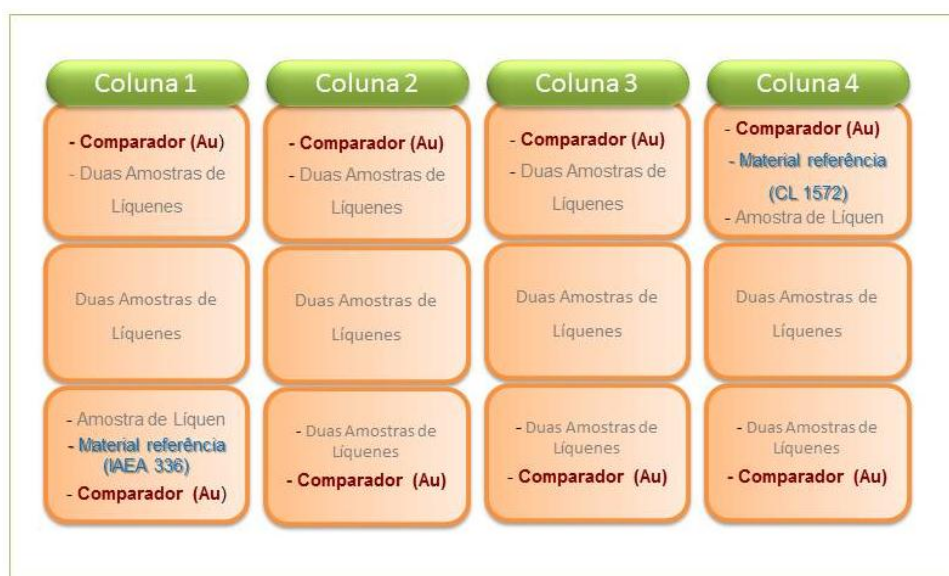
Figura 20- Representação esquemática da preparação de amostras para irradiação (fonte própria).
