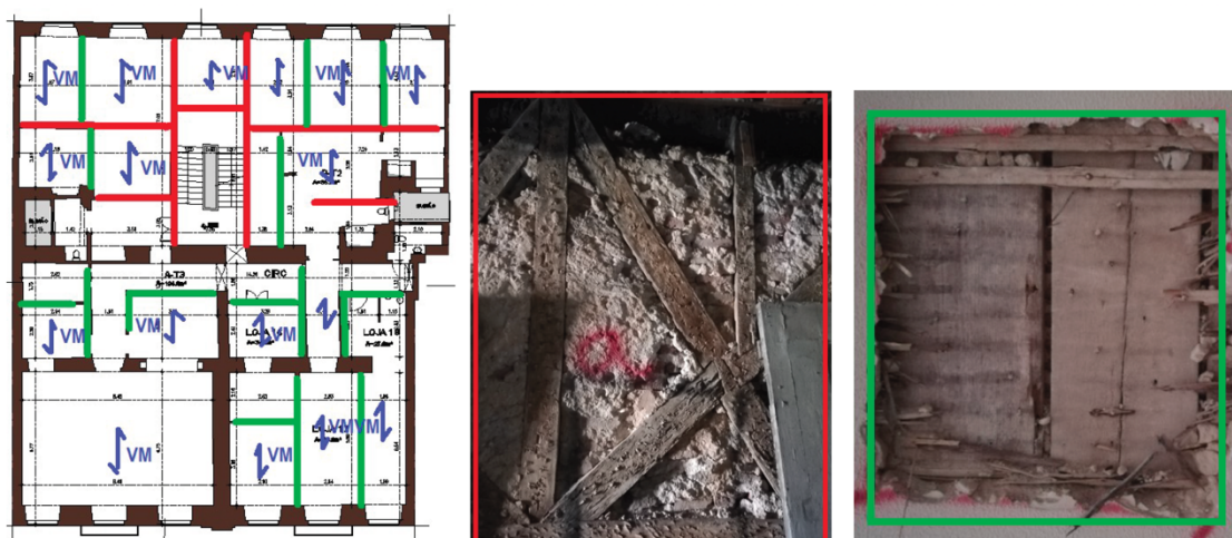
Figura 20. Alinhamentos de paredes interiores, frontal (vermelho) e tabique (verde). Orientação do vigeamento em madeira de apoio dos pavimentos, setas azuis. Fonte: Relatório sobre o sistema estrutural da autoria do Engenheiro Luís Gião Marques.
