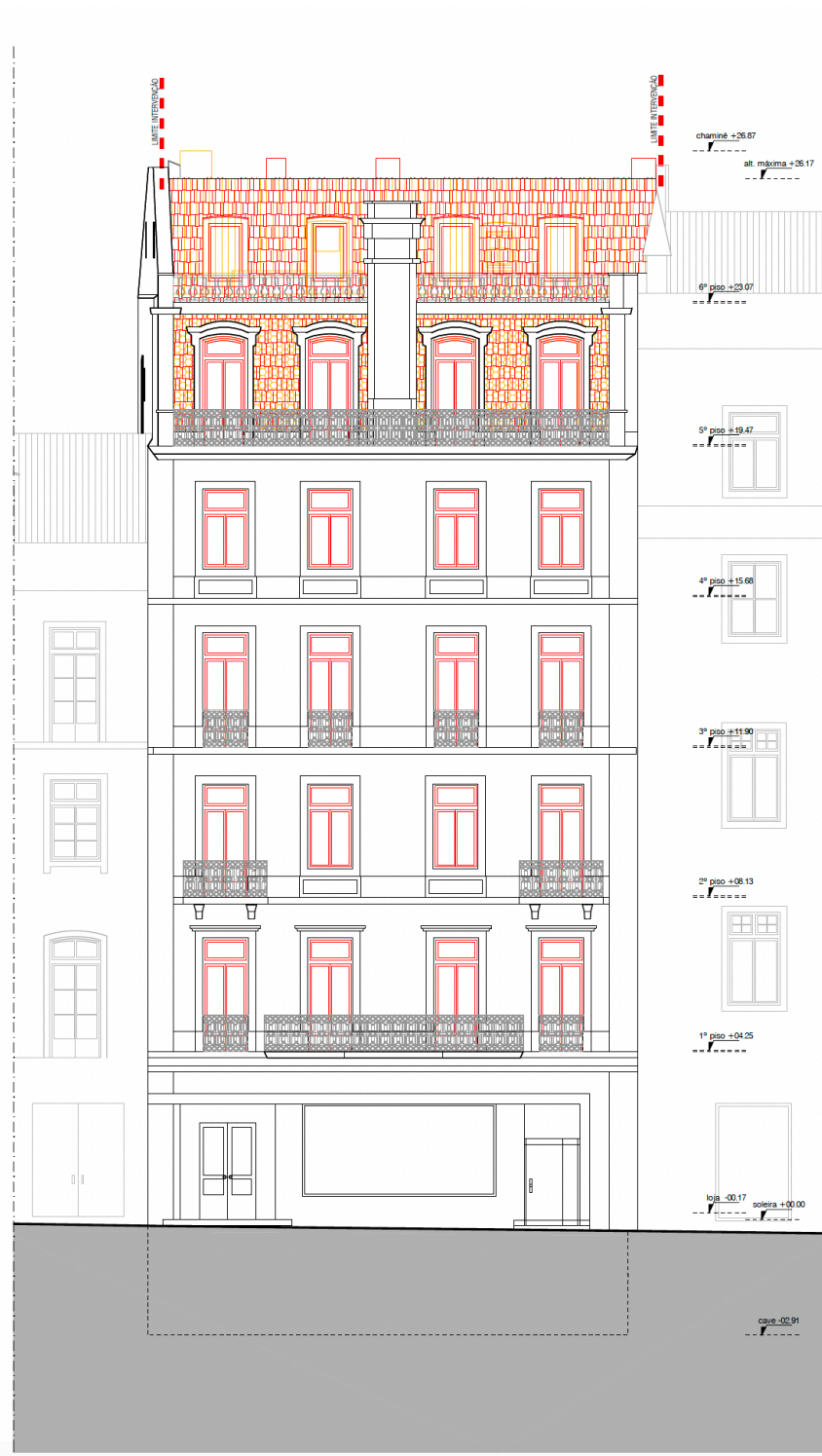
Figura 51. Edifício na Praça dos Restauradores, 53-56; alçado, mostrando a substituição das caixilharias e a abertura de trapeiras na parte superior da cobertura (2014).
