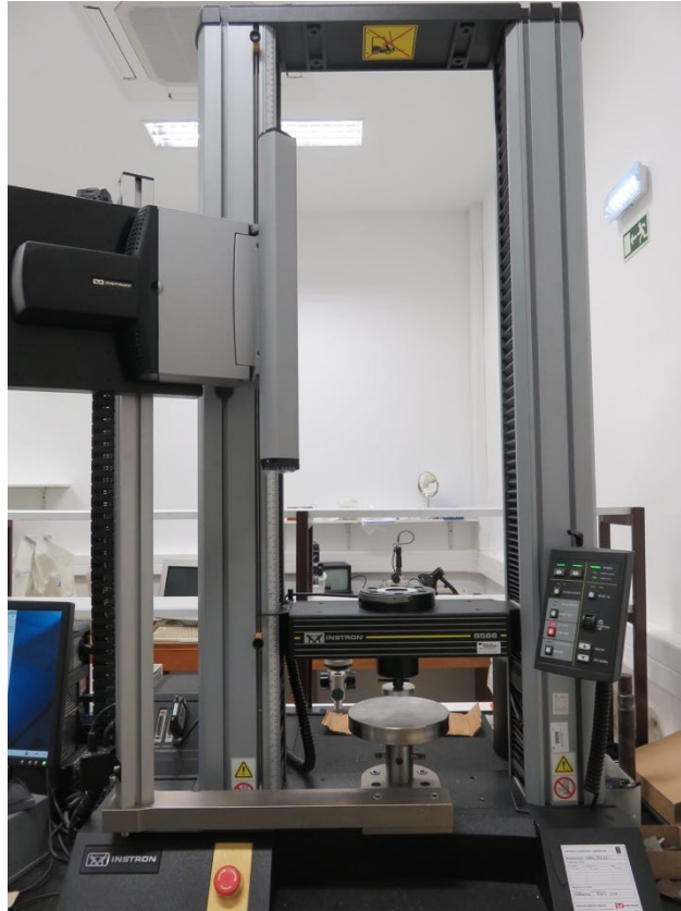
Figura 7 - Máquina de compressão Instron modelo 5566 (Departamento de Engenharia Mecânica do IST) utilizada neste estudo.
