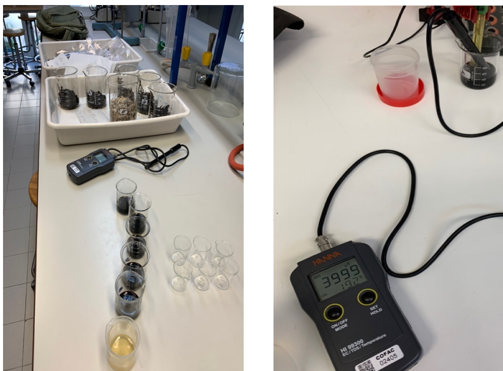
Figura 52 - Aparelho usado para a medição da condutividade elétrica das amostras.
