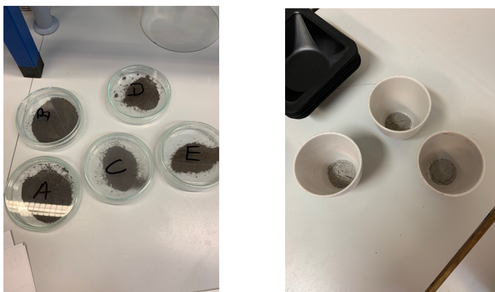
Figura 49 - Amostras desagregadas e cinzas resultantes da destruição da MO
