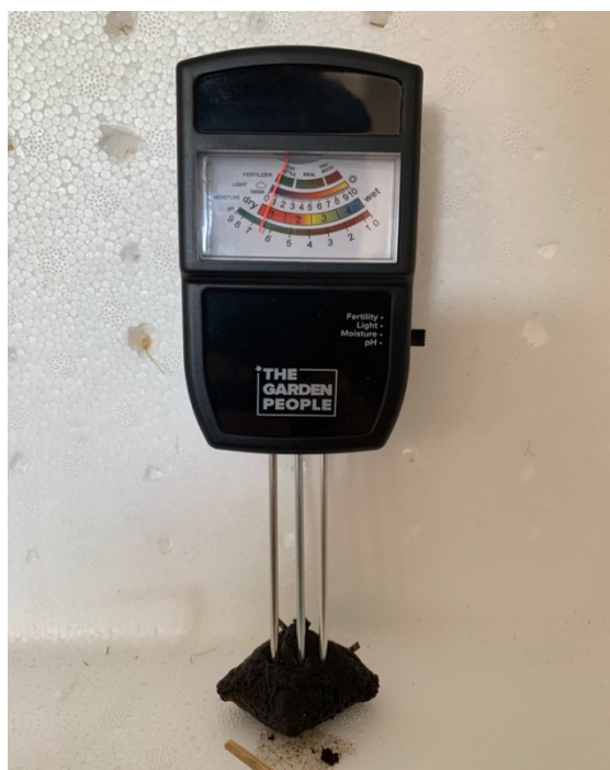
Figura 33 - Medição do valor de pH numa amostra do vermicomposto do ensaio E
