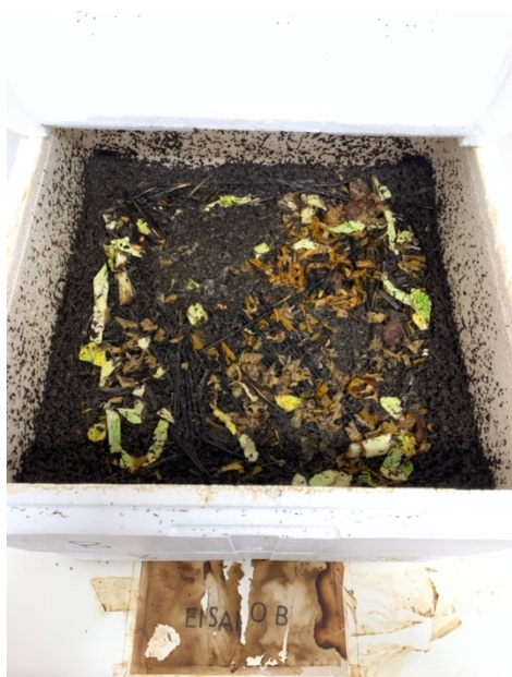
Figura 48 - Destruição da sinalética existente na bancada devido à perda de lixiviado no ensaio B e C
