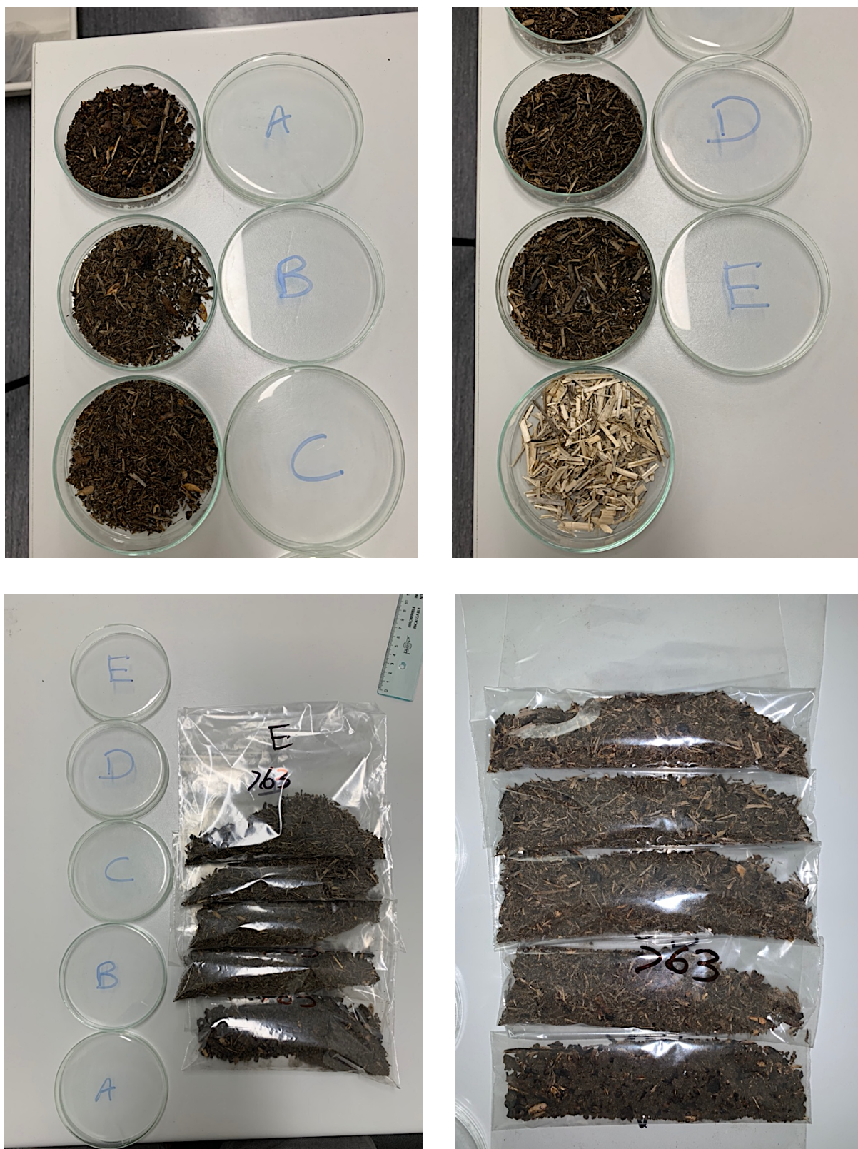
Figura 61 - Amostras da fração grosseira ( > 63 \mu\text{m} ) do vermicomposto de cada ensaio e dos resíduos de cânhamo
