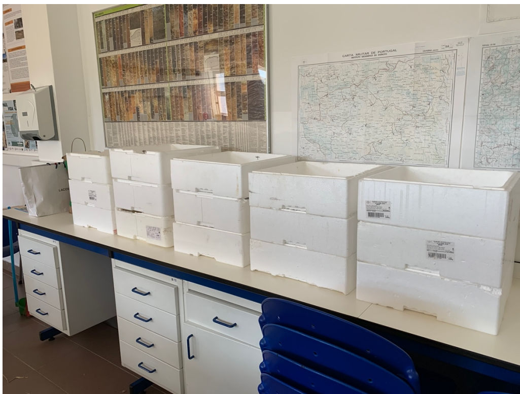
Figura 18 - Estrutura do sistema de vermicompostagem, com 5 ensaios contendo 3 caixas/gavetas cada ensaio
