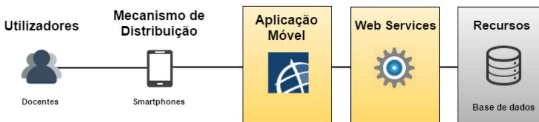
Figura 44: Diagrama da Arquitetura de Sistema para a consulta e lançamento de sumários. Fonte: Autor
