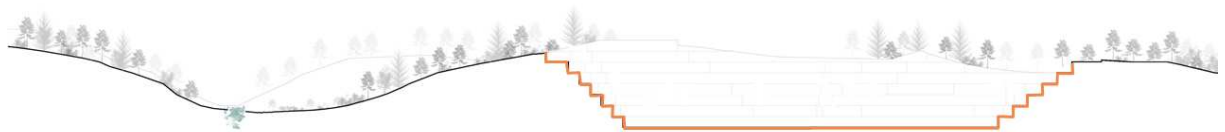
Figura 36. Desenho Esquemático do Perfil Previsto da Serra de Atouguia a 40 anos, com plano de lavra a laranja.
