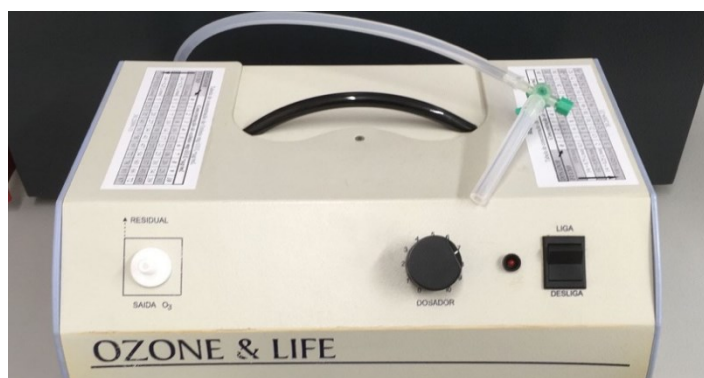
Figura 3: Gerador de ozono utilizado no estudo. Modelo da Ozone&Life O&L3 ORM. Foto cedida por Iris Fidalgo.
