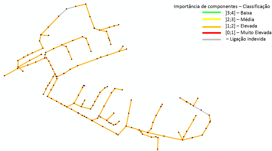
Figura A.59 – Importância de componentes com base na avaliação da velocidade mínima de escoamento, para um cenário de fc = 16 e um nível de sedimentação de 60%
