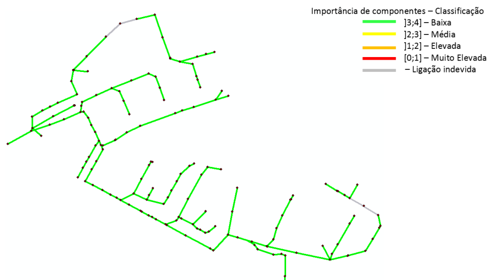
Figura A.27 – Importância de componentes com base na avaliação da altura de escoamento, para um cenário de fc = 2 e um nível de sedimentação de 60%
