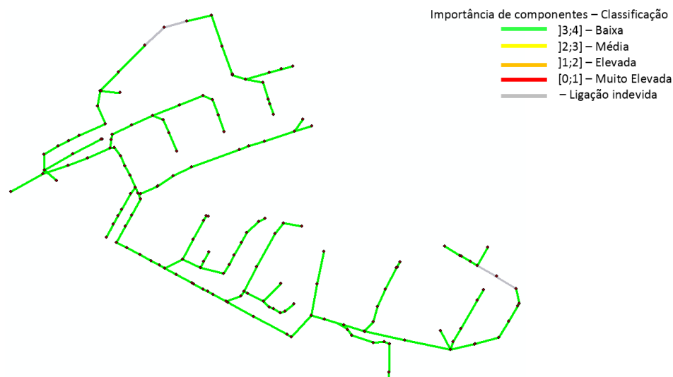
Figura A.42 – Importância de componentes com base na avaliação da altura de escoamento, para um cenário de fc = 4 e um nível de sedimentação de 60%
