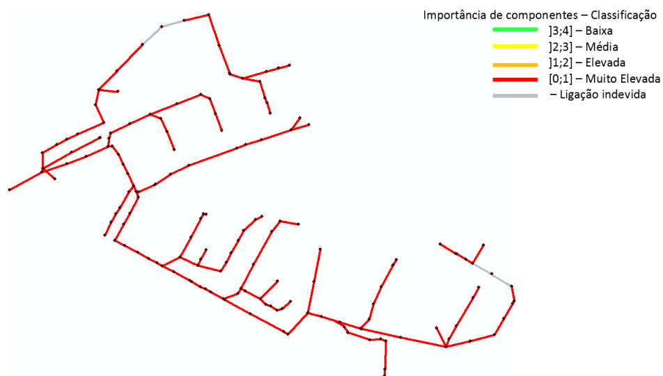
Figura A.58 – Importância de componentes com base na avaliação do extravasamento de câmaras de visita, para um cenário de fc = 16 e um nível de sedimentação de 60%
