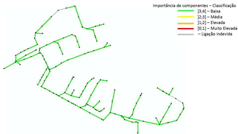
Figura A.13 – Importância de componentes com base na avaliação do extravasamento de câmaras de visita, para um cenário de fc = 1 e um nível de sedimentação de 60%
