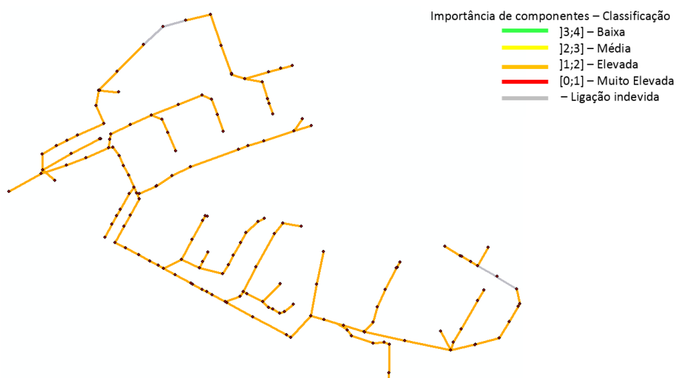
Figura A.30 – Importância de componentes com base na avaliação da velocidade máxima de escoamento, para um cenário de fc = 2 e um nível de sedimentação de 60%
