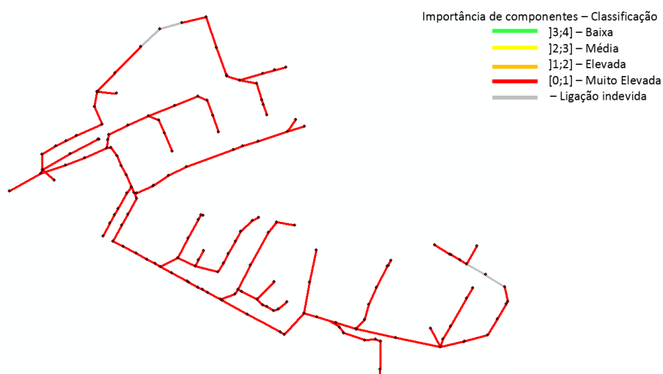
Figura A.14 – Importância de componentes com base na avaliação da velocidade mínima de escoamento, para um cenário de fc = 1 e um nível de sedimentação de 60%
