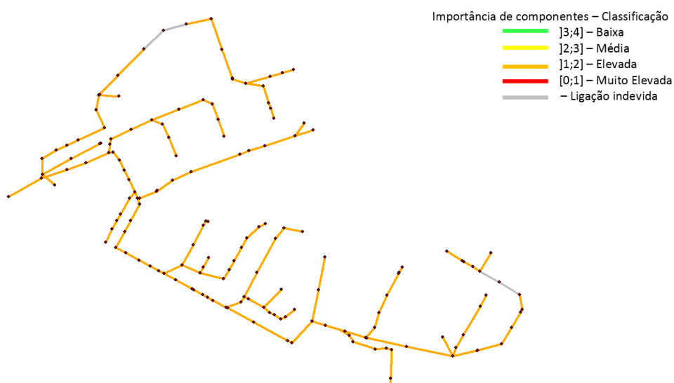
Figura A.44 – Importância de componentes com base na avaliação da velocidade mínima de escoamento, para um cenário de fc = 4 e um nível de sedimentação de 60%
