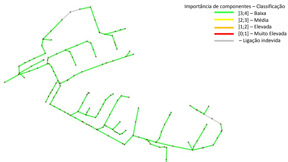
Figura 60 – Importância de componentes com base na avaliação da altura de escoamento, para um cenário de fc = 8 e um nível de sedimentação de 60%
