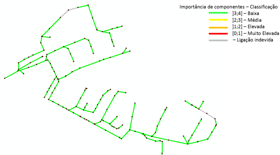
Figura A.43 – Importância de componentes com base na avaliação do extravasamento de câmaras de visita, para um cenário de fc = 4 e um nível de sedimentação de 60%
