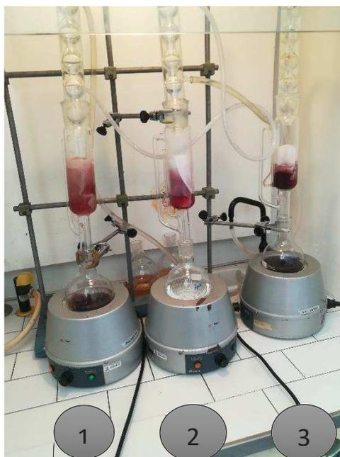
Figura 50 - Montagens de Soxhlet após 2 ciclos (Produção própria).
