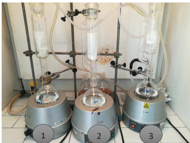
Figura 49 - Montagens de Soxhlet Solventes: 1- água e etanol; 2- água; 3- etanol (Produção própria).
