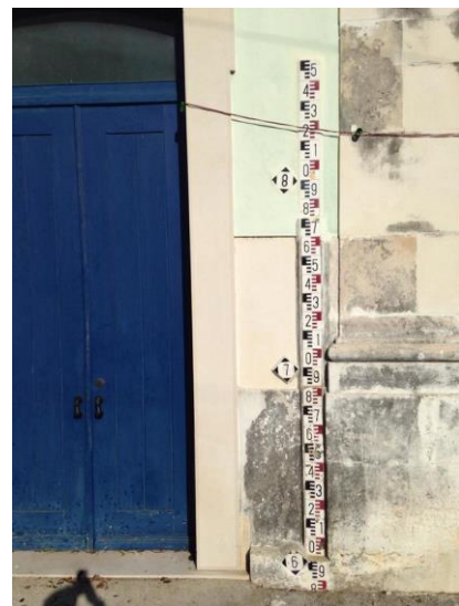
Figura 3 - Medição da profundidade das antigas cheias
