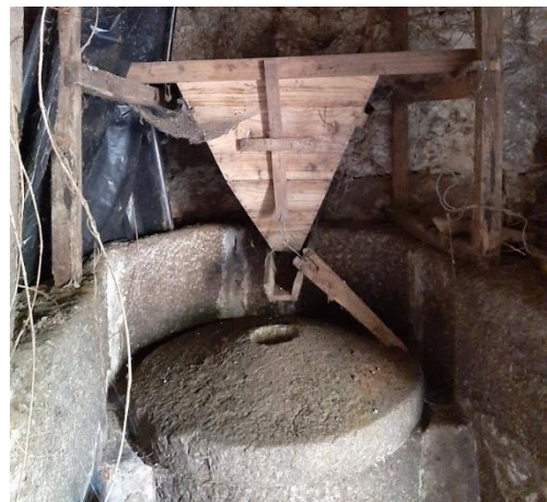
Figura 121- Pormenor da adalha e mós
