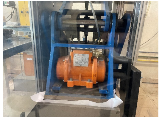
Figura 3.13 – Compactação das lajetas
