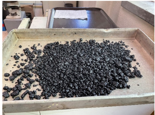
Figura 3.11 – Mistura sem compactação
