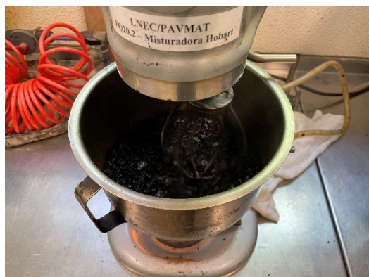
Figura 3.8 – Mistura betuminosa para moldagem do provete cilíndrico
