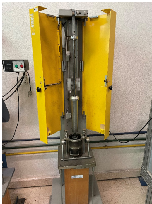
Figura 3.9 – Compactação do provete cilíndrico
