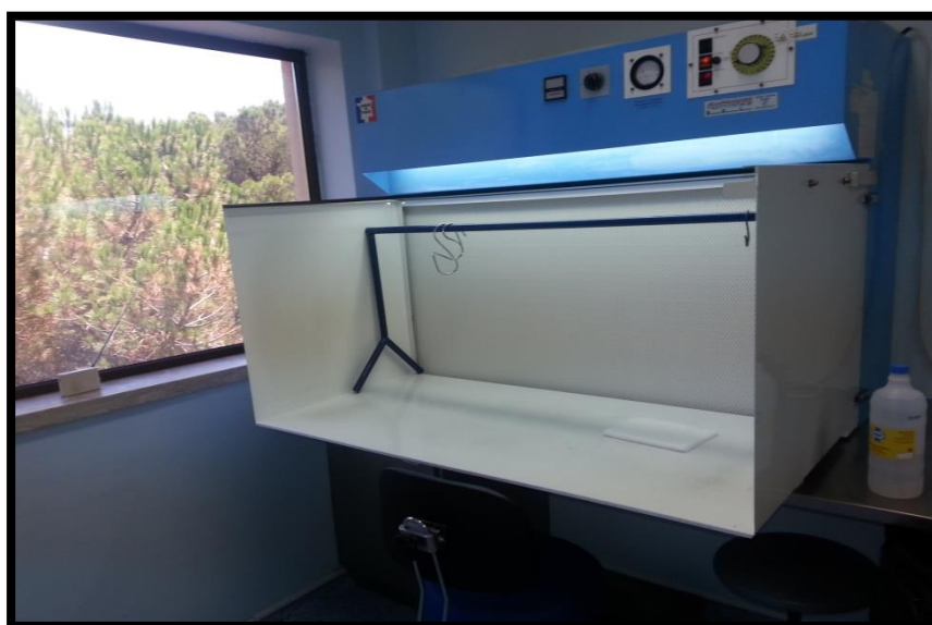
Figura 4- Câmara de Fluxo Laminar do Hospital São Francisco Xavier
