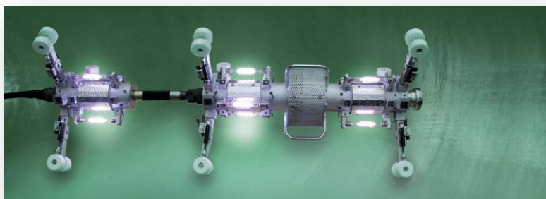
Figura 28 – Conjunto de lâmpadas de ultravioleta em progressão no processo de cura da manga (MANVIA, 2007)
