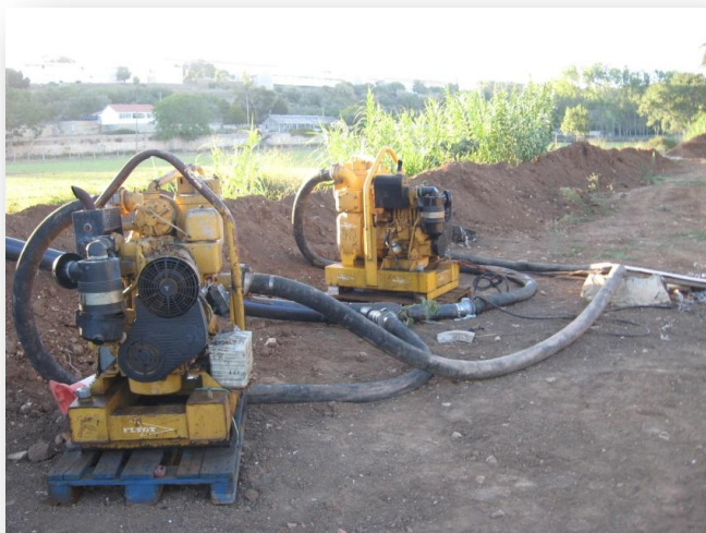
Figura 49 – Bombas diesel de 4 polegadas a pistão para transfega de caudais (MANVIA, 2009)
