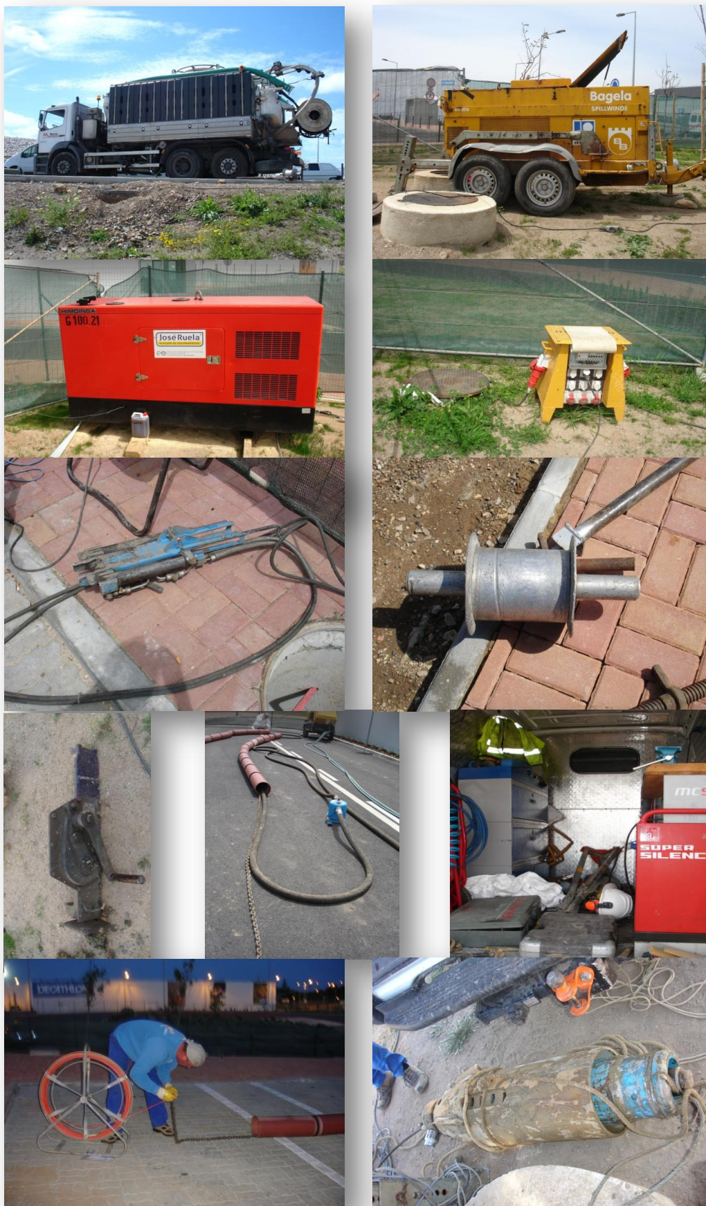
Figura 74 – Equipamentos para a execução do entubamento com rebentamento, incluindo, equipamento especial – Caso de Estudo 2
