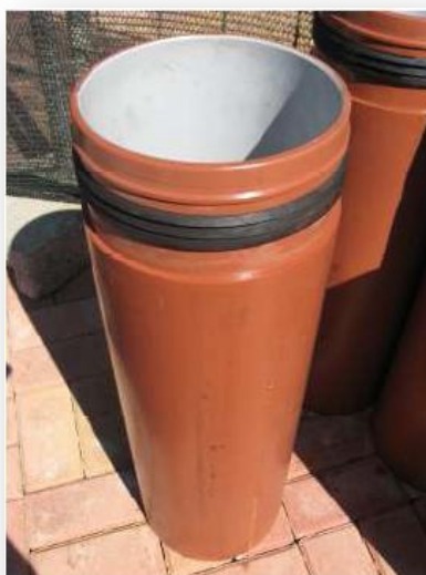
Figura 82 – Tubo modular com um comprimento total de 0,70 m diâmetro exterior com 225 mm, correspondendo ao diâmetro interior de 199,4 mm – Caso de Estudo 2
