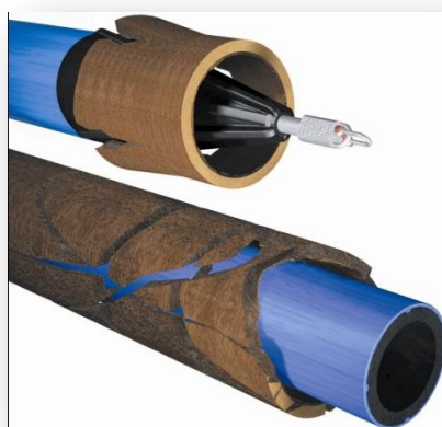
Figura 45 – Tubagem de grés destruída durante o « burstlining » com introdução de novos tubos em Polipropileno (PP) (MANVIA, 2007)
