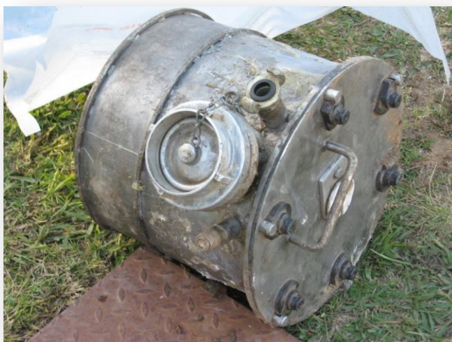
Figura 25 – Cabeçote de chego da manga sendo visível a entrada de ar para o processo de insuflação (MANVIA, 2007)
