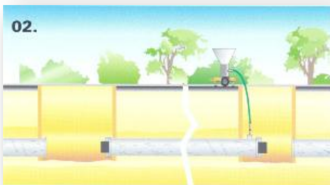
Figura 33 – (01), (02) - Entubamento com tubos convencionais (MANVIA, 2007)
