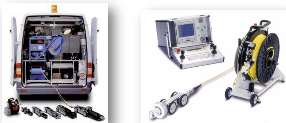
Figura 53 – Inspeção vídeo robotizada de tubagens enterradas e equipamento de « Closed-Circuit Television » (CCTV) sistema IBAK MIDI DN100-DN800 (MANVIA, 2007)
