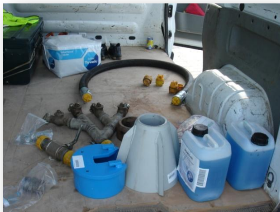
Figura 77 – Materiais consumíveis utilizados no encamisamento por rebentamento – Caso de Estudo 2
