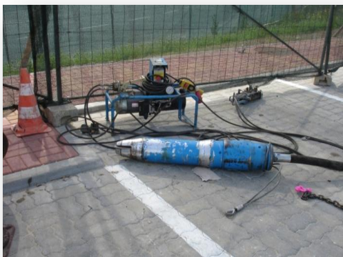
Figura 91 – Cabeça de rebentamento pneumática (antes de depois do entubamento por rebentamento) – Caso de Estudo 2
