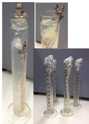
Figura 7 - Concentração do extrato através de membrana de diálise submersa em PEG (Fonte: Laboratório de Microbiologia, DAN, INSA)
