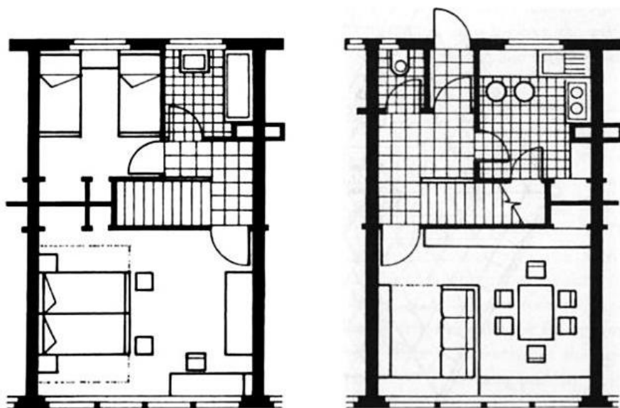
Figura 19: Proposta de uma existenzminium de dois pisos de Walter Gropius
