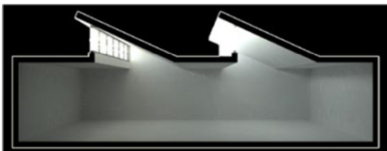
Fig. 1 Exemplo de abertura zenital lateral; Fonte. www.deviris-pt.com
