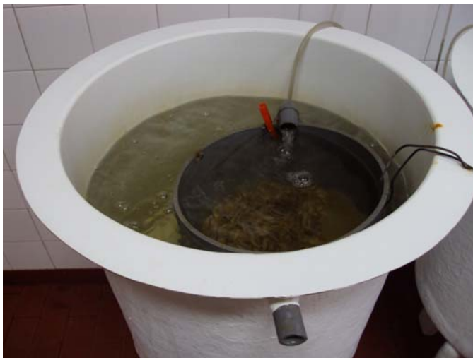
Figura 2- Manutenção dos juvenis de R. decussatus em crivo com uma malhagem de 500 \mu m provido de ‘air-lift’ para aerificar a água, num tanque de 80L.
