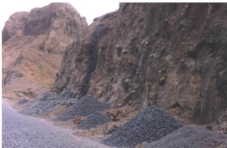
Figura 2.24 – Exploração de um filão basáltico para a produção manual de brita, Serra da Malagueta, ilha de Santiago.
