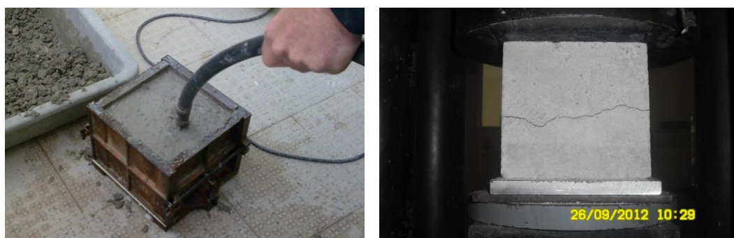
Figura 6.3 – Ensaio de resistência à compressão do betão.
