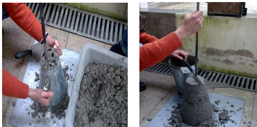
Figura 6.2 – Ensaio do abaixamento do cone de Abrams.
