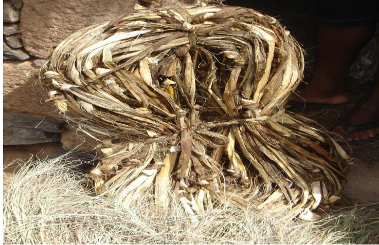
Figura 2.21 – Sisal que é utilizado para efetuar os amarramentos nas coberturas de palhas (Sampaio, 2006).
