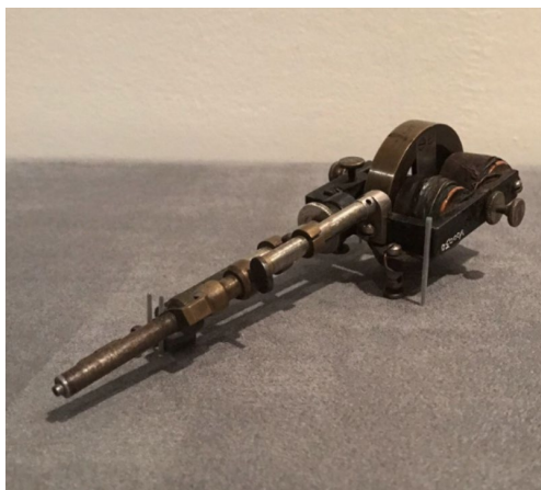
Figura 1 Exemplo da máquina de tatuagem patenteada por Sam O'Reilly. Connor, (2023).
