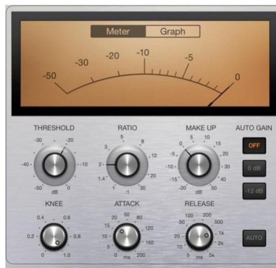
Figura 14: Parâmetros do compressor
