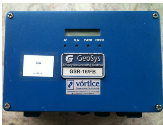
Figura 3.3 – Aparência de um acelerómetro Geosys SSA-320 GSR-16
