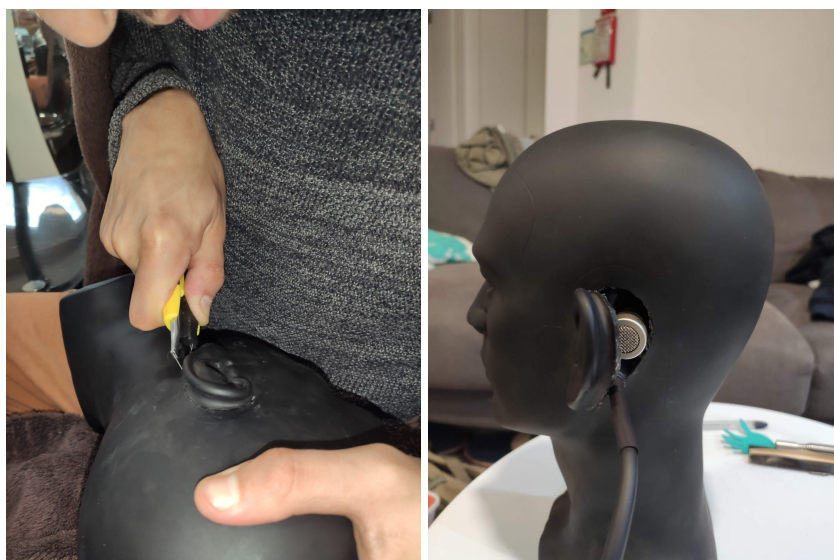
Figura 13 - Construção do protótipo do microfone binaural
