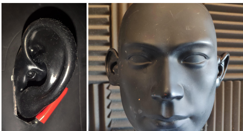
Figura 14 - Protótipo do microfone binaural (Orelhas silicone + Microfones lapelas)
