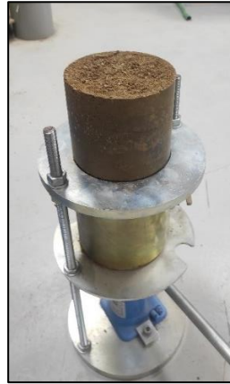
Figura 3.17 – Processo de desmoldagem dos provetes
