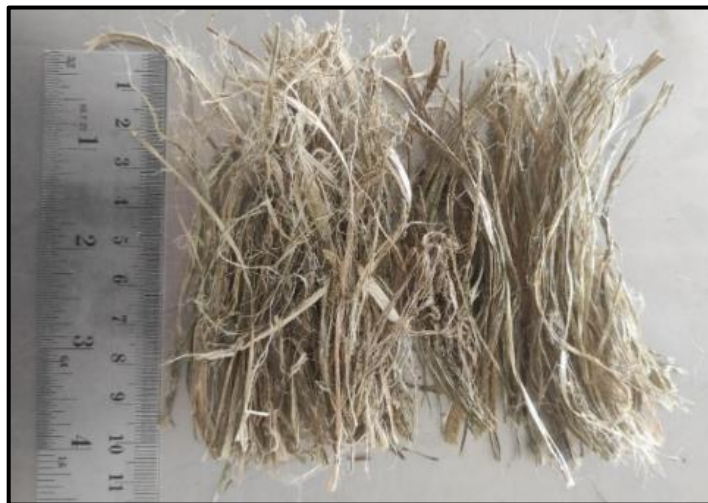
Figura 3.11 – Fibras secas, separadas e cortadas com aproximadamente 10 cm
