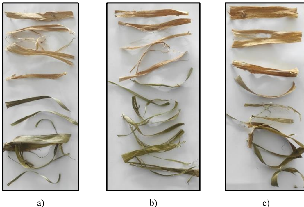
Figura 3.9 – Secagem das fibras: a) temperatura ambiente (24h) b) 50° em estufa (24h) c) 100°C em estufa (24h)
