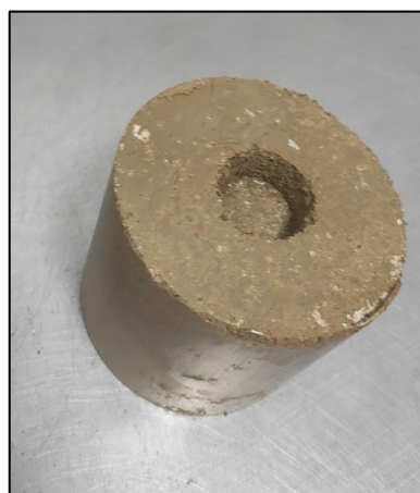
Figura 4.14 – Aspeto geral do provete após o ensaio de determinação do índice de California Bearing Ratio e respetiva desmoldagem
