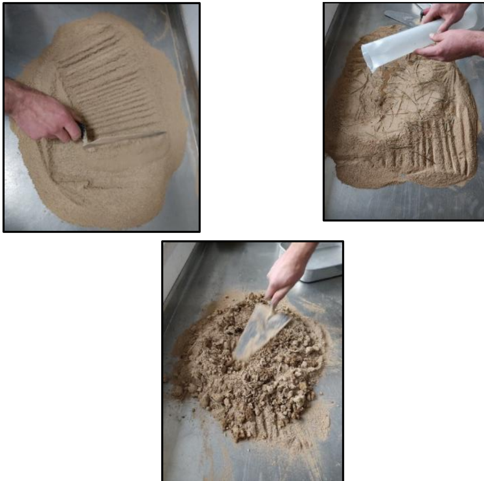
Figura 3.14 – Processo de mistura dos agregados, cimento, água e fibras
