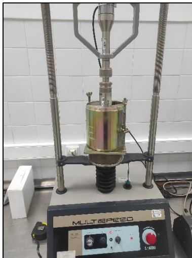
Figura 4.12 – Realização de ensaio de determinação do índice de California Bearing Ratio
