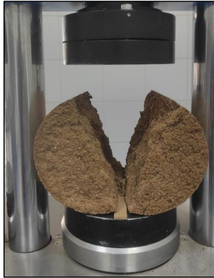
Figura 4.10 – Provete sem reforço com fibras, após o ensaio à tração indireta
