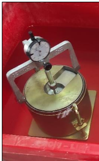
Figura 4.11 – Provete submerso com as placas de carga e tripé com defletômetro
