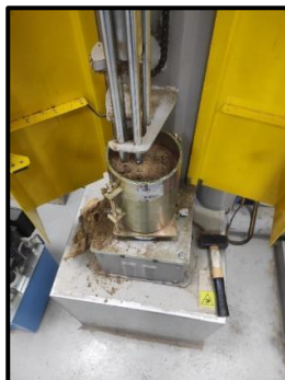
Figura 3.15 – Processo de compactação dos provetes
