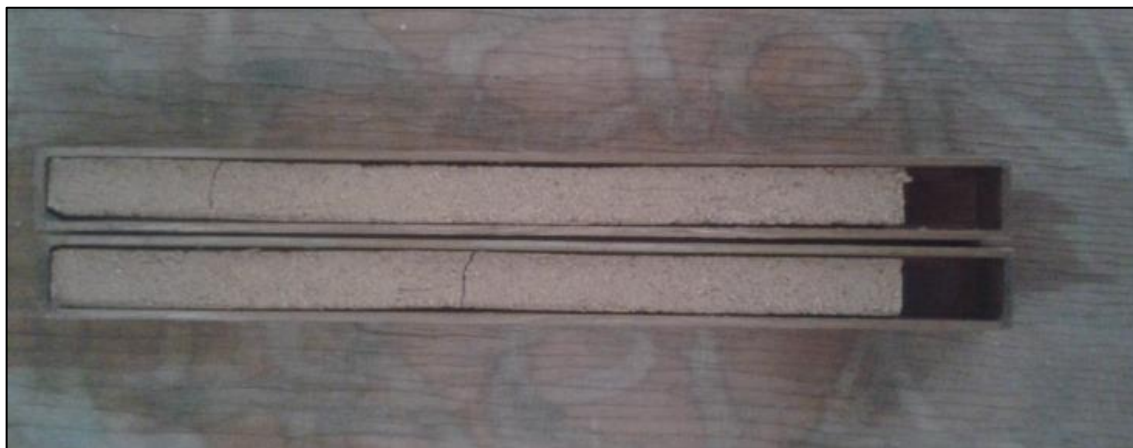
Figura 4.2 – Calha com material após secagem
