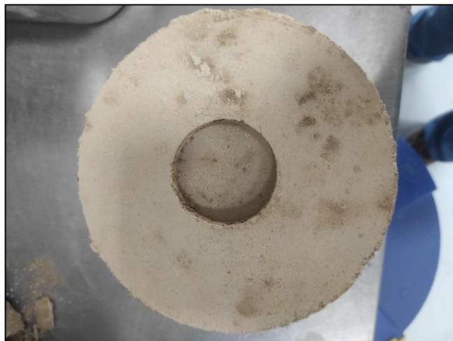
Figura 4.19 – Aspeto geral do provete após o ensaio de determinação do índice de California Bearing Ratio imediato e respetiva desmoldagem
