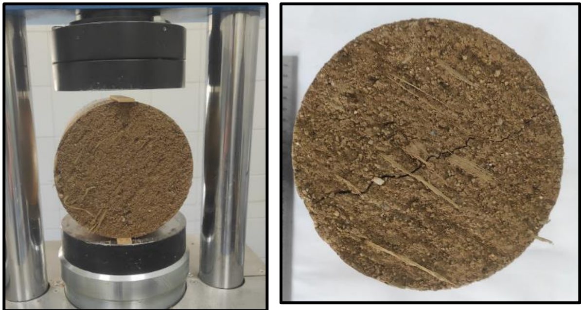
Figura 4.9 – a) provete antes do ensaio à tração indireta b) provete após o ensaio à tração indireta
