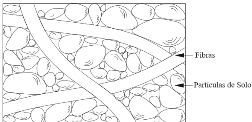
Figura 2.10 – Interação solo-fibra adaptado de (Liu et al., 2020)
