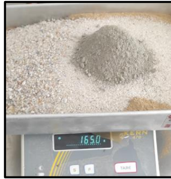
Figura 3.13 - Pesagem dos agregados e cimento
