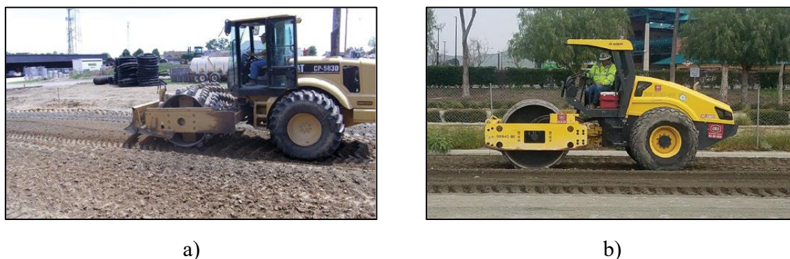
Figura 2.3 – Exemplos de cilindros compactadores: a) cilindro com pés de carneiro b) cilindro de rasto liso (Gross & Adaska, 2020)
